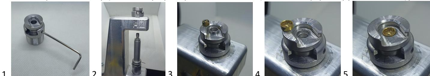
Шток капсюлятора устанавливается в гнездо для шелхолдера в прессе (фото 2) и поднимается в верхнее положение до упора. При установке капсюлей ход штока капсюлятора вверх-вниз составляет не более 10 мм и **не следует** опускать его полностью вниз. Капсюли диаметром до 5,5 мм устанавливаются в приподнятый над шелхолдером стаканчик капсюлятора (фото 3). Для установки капсюлей диаметром 6,55 мм шток капсюлятора нужно опустить на 2-3 мм в отверстии шелхолдера (фото 4 и 5).
